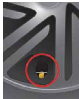
Неправильное положение вентиля: под кольцом.
