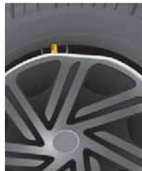
Край декоративного колпака деформирован возле вентиля из-за неправильной установки.
