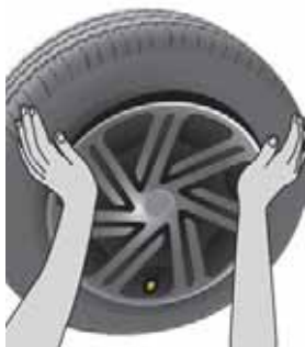
Неправильное положение края декоративного колпака.
